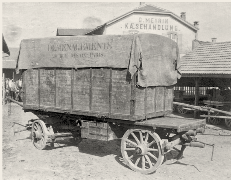
Schon 1892 erledigte Settelen internationale Umzüge. Bei diesem Möbelwagen aus Paris handelt es sich um einen «Cadre», der dem kombinierten Verkehr Bahn – Strasse diente. Er bestand aus einer Bodenpalette mit herunterklappbaren Wänden und einer Deckplane.
