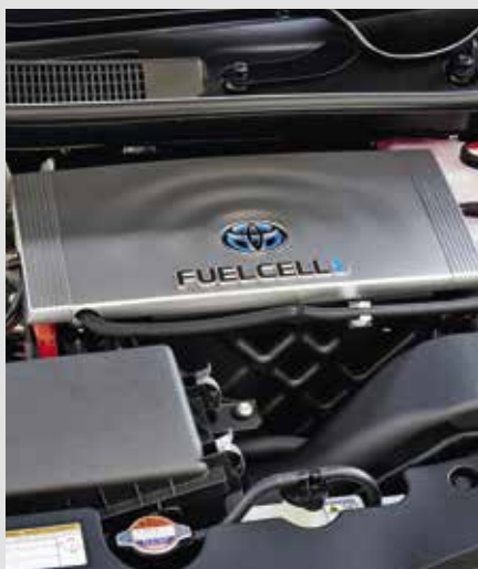
Saubere Sache Brennstoffzelle: Aus dem Auspuff kommt nur Wasserdampf
