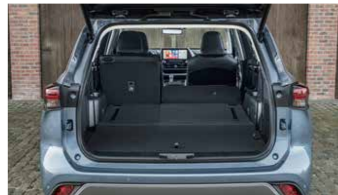
Der flexibel aufteilbare Kofferraum bietet 658 Liter Volumen bei sieben Sitzen, mit umgeklappten Sitzreihen sogar 1909 Liter
