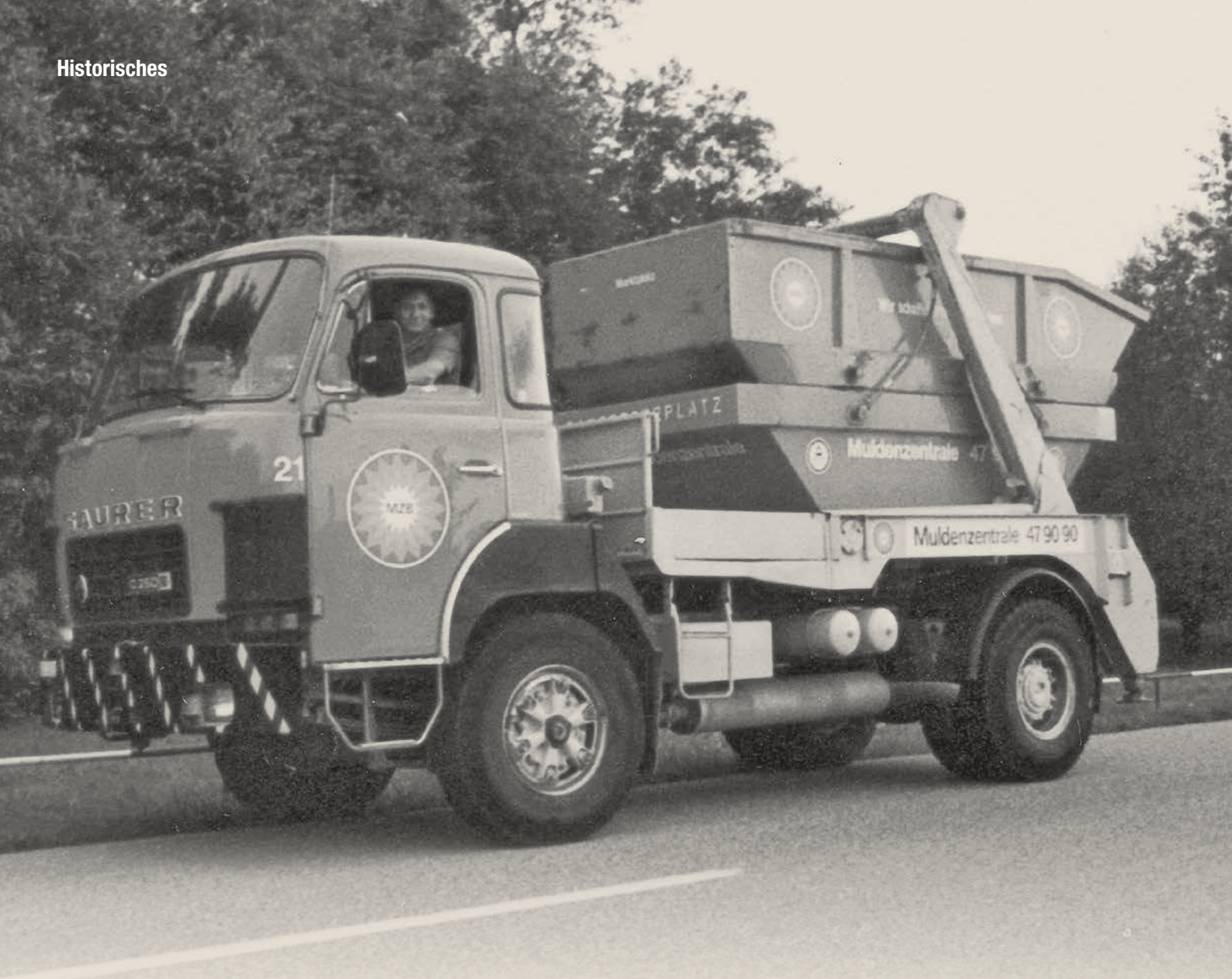
Ein Saurer D 250 Wechselladekipper; er «arbeitete» von 1983 bis 1995 für die Muldenzentrale (1984)
