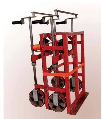
Schaufel der Geräte unter die Stirnseiten des Transportgutes schieben, Span-Set anbringen, Ladegut gleichmässig mit ein paar Pumpbetätigungen anheben und wegrollen
